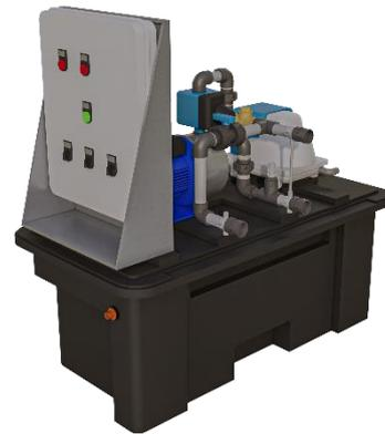
En cuanto la bomba de superficie proceda a aspirar el efluente tratado, aspirará también una dosis determinada de solución de hipoclorito de sodio de forma que se proceda a la desinfección en línea del efluente. El conjunto formado por la tubería de la red y los depósitos de descarga determinará el tiempo de contacto necesario para que el agente desinfectante actúe sobre los microorganismos potencialmente patógenos.
